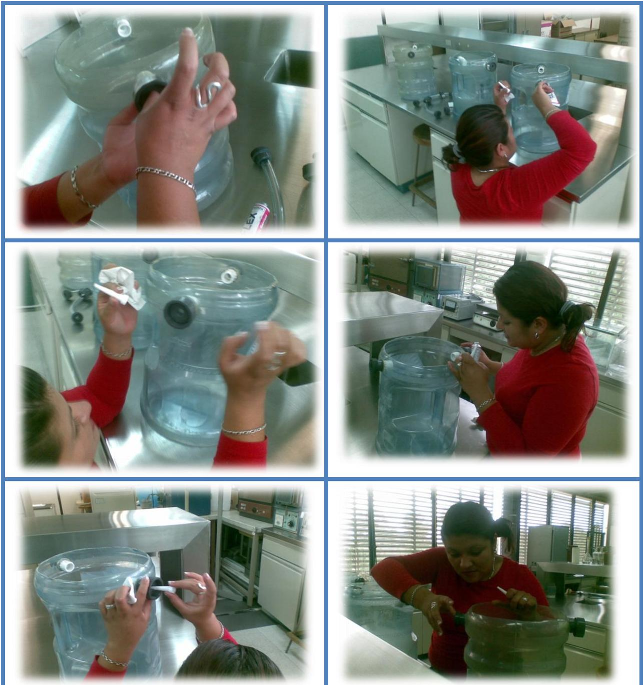
El armado del reactor, fue sellado de manera cuidadosa para que se evitara tener fugas y posibles infiltraciones de otro lugar que no fueran las uniones.
