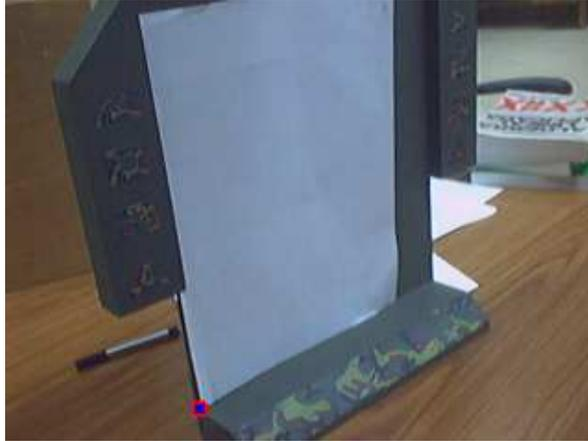
Figura 6.3: Fotografía del caballete sobre el que se colocará la hoja de papel para dibujar. Se marcan con puntos aquellas regiones de interés que se seleccionaron como clases para la identificación. El origen del mundo sería el punto marcado con un círculo grande
