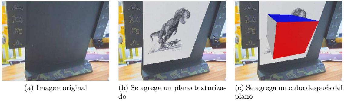
Figura 6.14: Al igual que en la figura 6.12, se obtienen los puntos de interés y se calibra la cámara, para después agregar objetos virtuales con base en la posición del objeto real de referencia.
