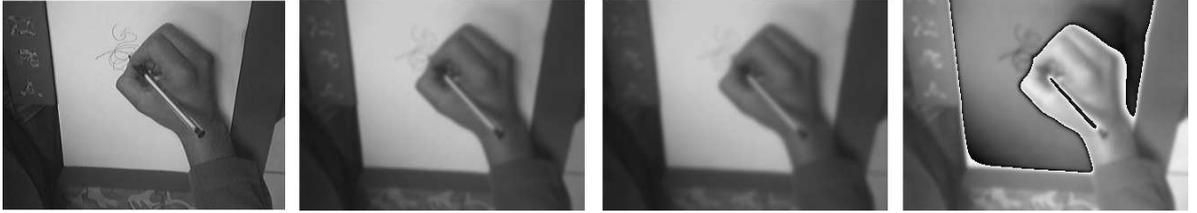
Figura 3.1: De izquierda a derecha: imagen original ( $I$ ), primer suavizado gaussiano ( $A = G(I)$ ), segundo suavizado gaussiano  $B = G(A)$ , diferencia de gaussianas  $D = A - B$
