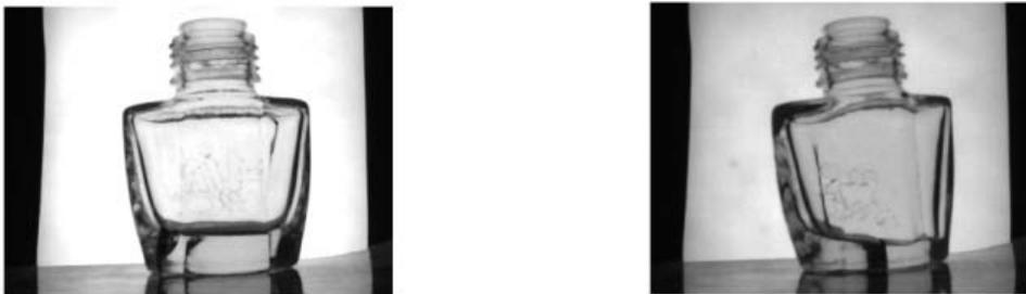
Figura 45. Morfología matemática (dilatación con elemento de estructura tipo disco de diámetro 3) de imágenes sin defectos.
