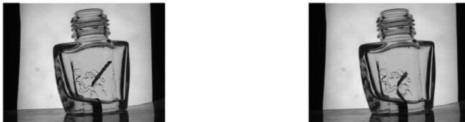
Figura 42. Imágenes de muestra con defectos.
