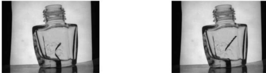
Figura 44. Morfología matemática (dilatación con elemento de estructura tipo disco de diámetro 3) de imágenes con defectos.
