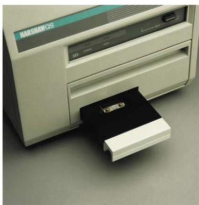
Fig. 4.4 El lector de los dosímetros TLD
