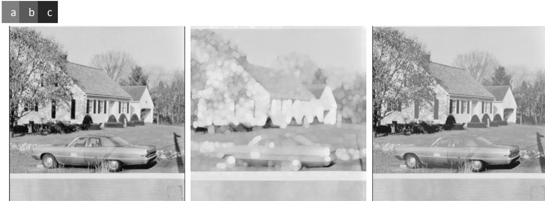
Figura 3. 25 Reconstrucción por erosión. (a) Imagen máscara; (b) Imagen marcadora; (c) Reconstrucción por erosión de la imagen máscara a partir de la marcadora.
