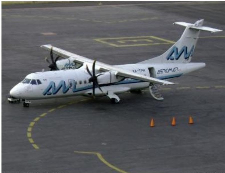
FIGURA 4.2.1 SEÑALAMIENTO CORRECTO DE LA PLATAFORMA
