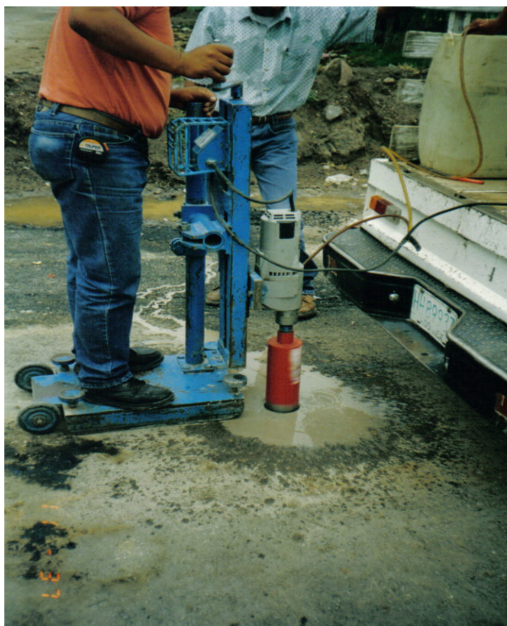
No. VI.31. Laboratorio haciendo el muestreo en la carpeta asfáltica, extrayendo corazones con máquina extractora.
