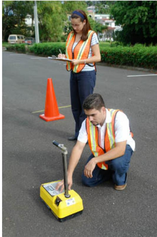
Fig. 4.11 Inspección de pavimentos
