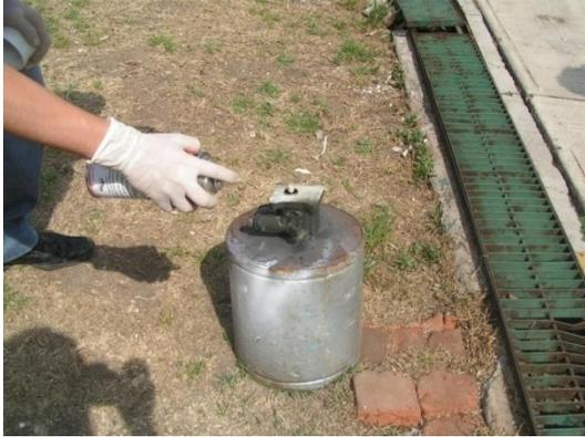
Se realizó la aplicación del recubrimiento DRILUBE PLUS. Esta operación se realizó al aire libre y con protección personal como son gafas, guantes y mascarilla, ya que el lubricante es altamente inflamable y tóxico para el ser humano.
