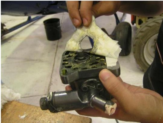
La imagen muestra el desprendimiento del enmascarado previo a instalar la bomba.
