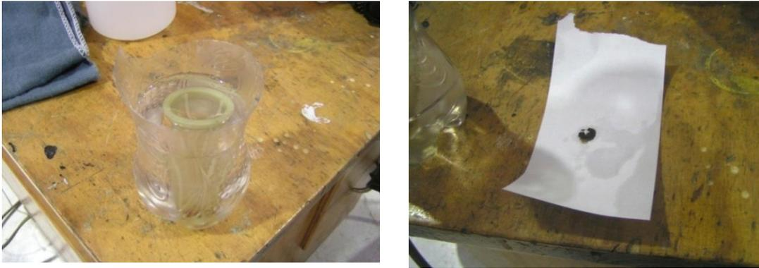
Limpieza del filtro tipo malla del depósito del sistema hidráulico. Este presentó residuos de líquido hidráulico en la base del filtro, debido a la falta de mantenimiento del mismo.
