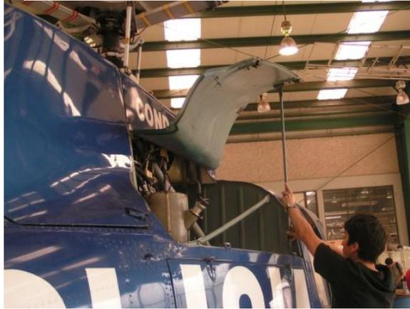
**NOTA:** Los tornillos solamente son de aseguramiento. Con 1/4 de vuelta el seguro es desplazado.
