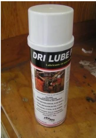
El Aerosol DRI LUBE PLUS se empleó para la lubricación del balero de la bomba de engranes. Este lubricante está hecho a base de 3% de sulfuro de molibdeno, el cual soporta altas revoluciones creando una película permanente anti-desgaste. Reemplazo el uso de grafito que se cristalizaba a altas temperaturas.
