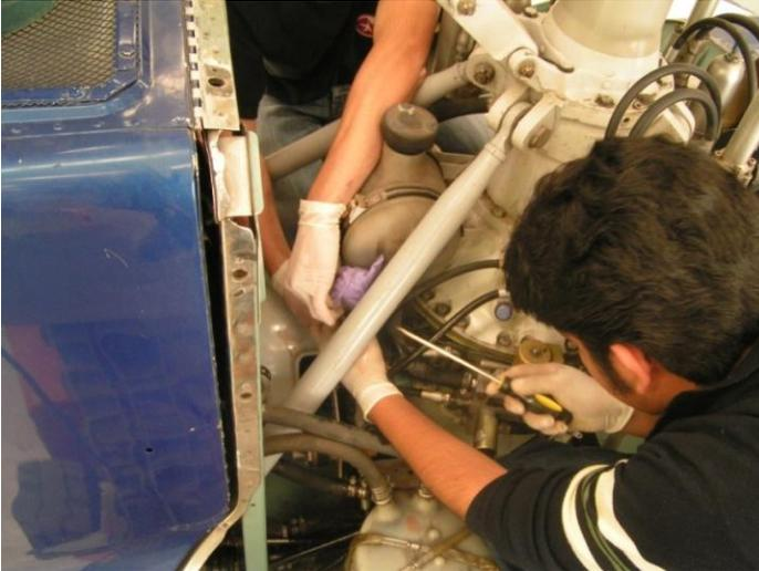
Primeramente se removieron las dos mangueras conectadas a la bomba. Una fue la manguera de succión del fluido hidráulico del depósito, la cual se estranguló y se clausuró para evitar la fuga del líquido hidráulico. De igual manera se canceló la manguera de distribución, para la completa remoción de la bomba. Al realizar dichos procedimientos se verificó el estado de las mangueras, las cuales no presentaron agrietamientos o erosión.
