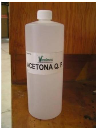
La acetona pura fue empleada para la limpieza de los componentes del sistema de acuerdo a lo indicado en el manual de mantenimiento. Es un agente menos agresivo para los componentes que están en contacto con el fluido hidráulico.
