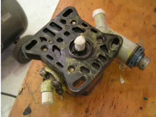
Se asilaron los puertos de conexión de la bomba y el piñón al aplicar el lubricante con el fin de evitar mezcla de fluido.
