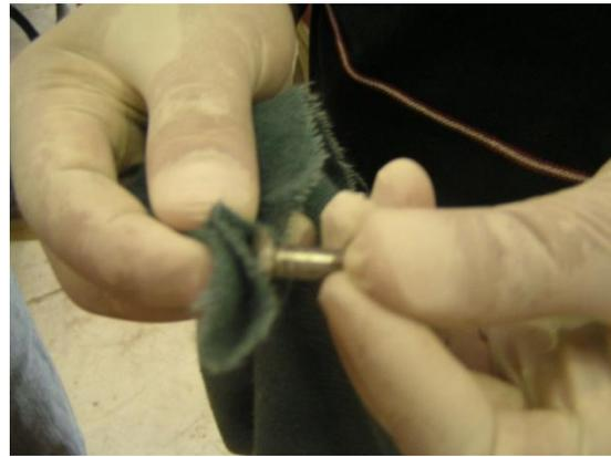
Se elaboró la limpieza de la tornillería, rondanas planas, rondanas de presión y las tuercas de la bomba. Así mismo se realizó la limpieza de cavidades internas y de difícil acceso para su mantenimiento.
