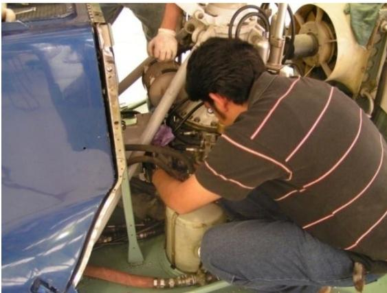
Se realizó la instalación de la bomba sin aplicar ninguna carga axial, es decir respetando las marcas señaladas previamente para su correcta colocación, así como el apriete adecuado de la tornillería. Verificó la tensión de la banda. Esta operación fue realizada sólo con el tacto, ya que no se cuenta con ningún tensiómetro en el laboratorio.
