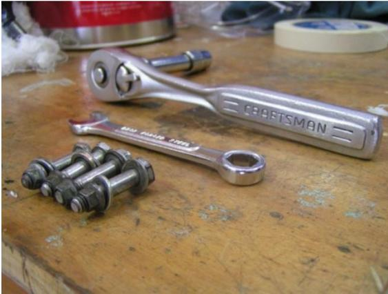
La matraca con un dado de 11mm y una llave española de 11mm para contra-vuelta se empleó para la instalación de la bomba.
