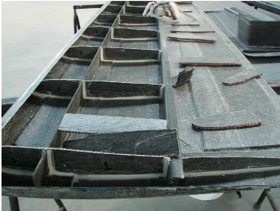
Figura 3.3 Configuración de la estructura del ala del Stela-M1.
