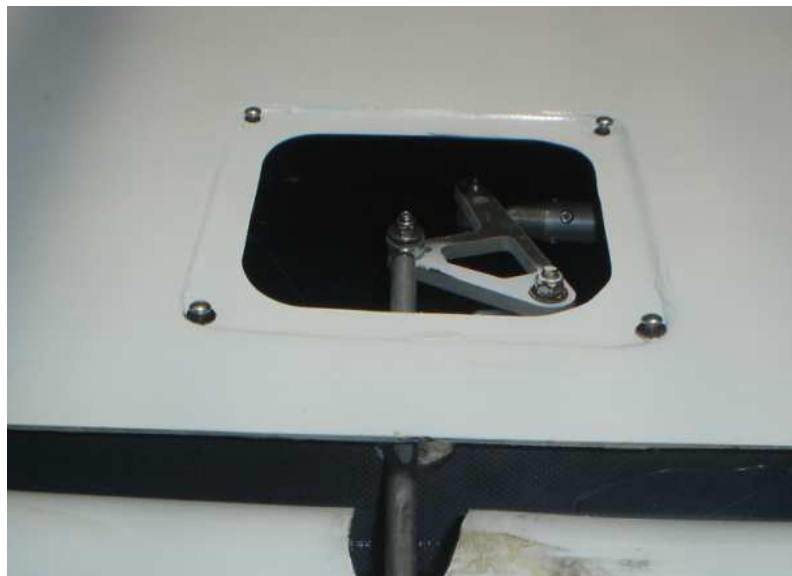
Figura 3.24 Registro de inspección que da acceso al sistema de flaps.
