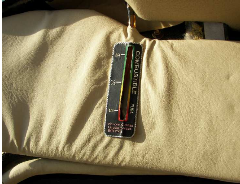
Figura 3.5 Indicación visual de nivel de combustible para cada tanque del Stela-M1.
