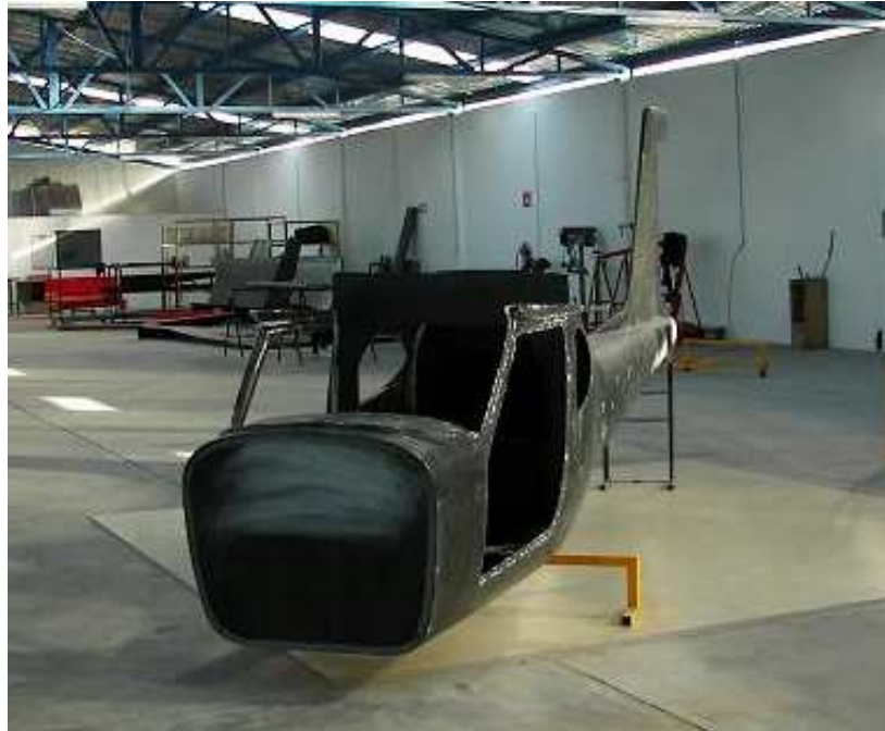
Figura 3.2 Fuselaje del Stela-M1 tipo monocasco.
