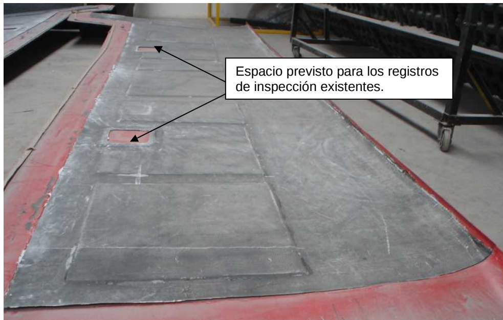
Figura 3.25 Molde de fabricación del intrados de la semiala izquierda.
