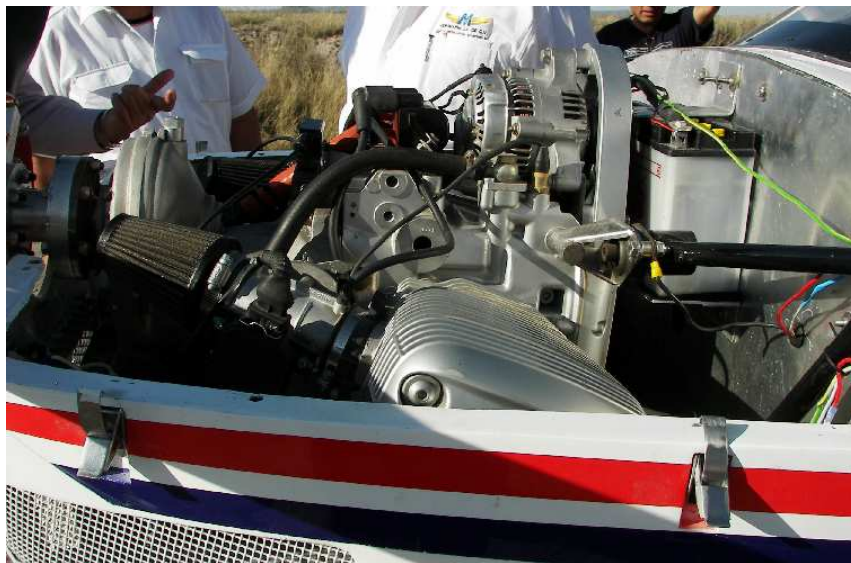
Figura 3.6 Motor alternativo JABIRU 2200 montado en el Stela-M1.
