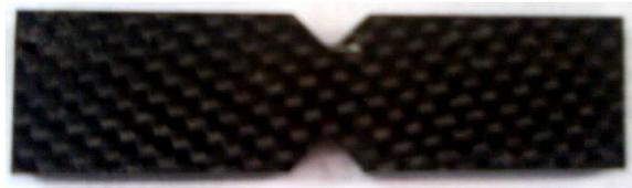
**Figura 5.2 Probeta de fibra de carbono**
