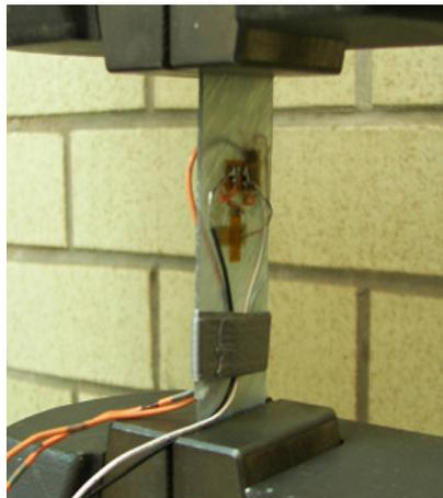
**Figura 2.12 Ensayo de tensión uniaxial en probeta de fibra de vidrio y resina poliéster**
