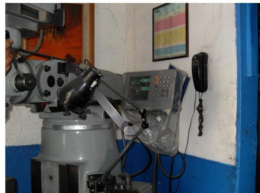
Figura 4.32 Detalle de la pantalla digital que permite acabados con mayor precisión.
