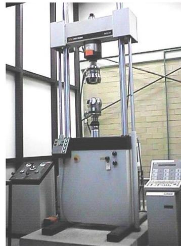
**Figura 4.4 Máquina servohidráulica Instron de ensayos universales**
