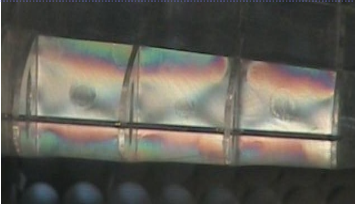
Fig. 5.4.1 Franjas de colores en los tres primeros claros de la viga de la semiala
