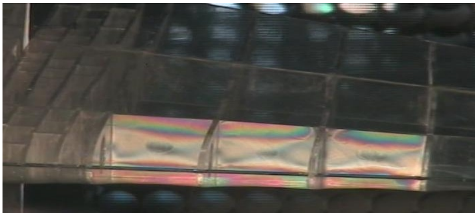
Fig. 5.3.3 f Polariscope a 0^\circ con tres motores encendidos.
