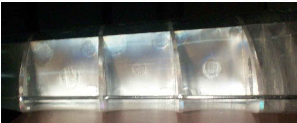
Fig. 4.2.21 Ensamble final del material birrefringente en la semiala.
