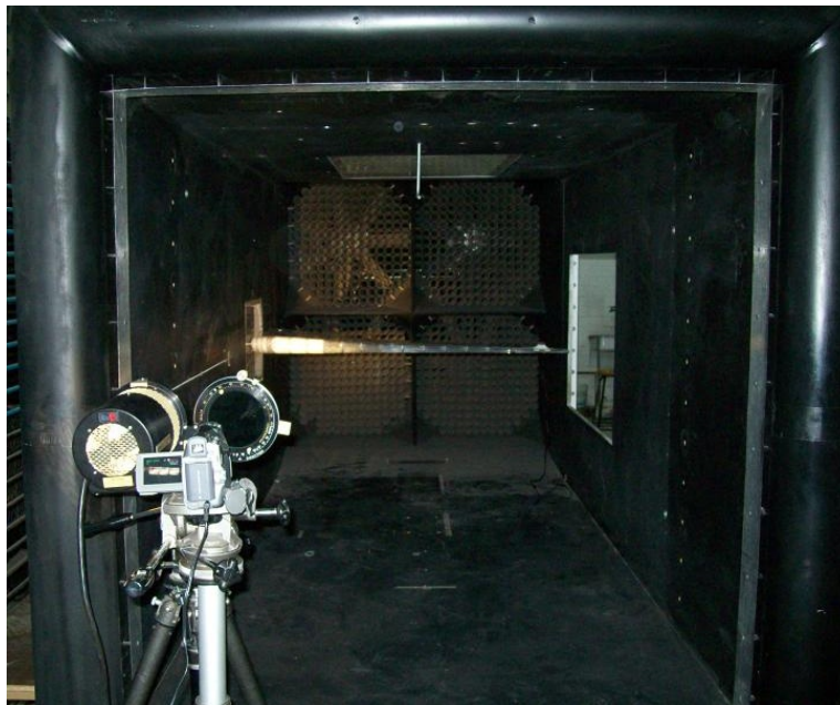
Fig. 4.3.3 Posicionamiento del polariscopio en el túnel.
