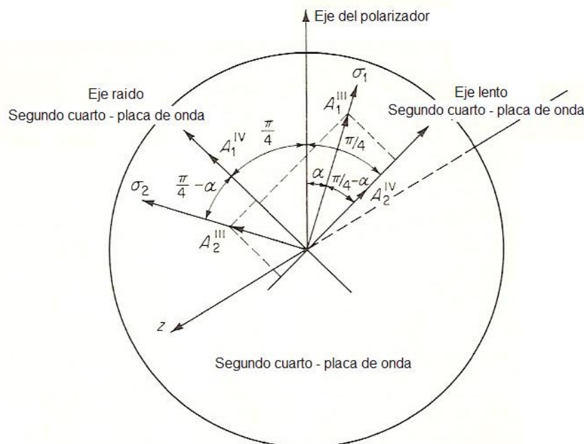
Fig. 1.3.15 Acercamiento de las componentes del vector de luz
