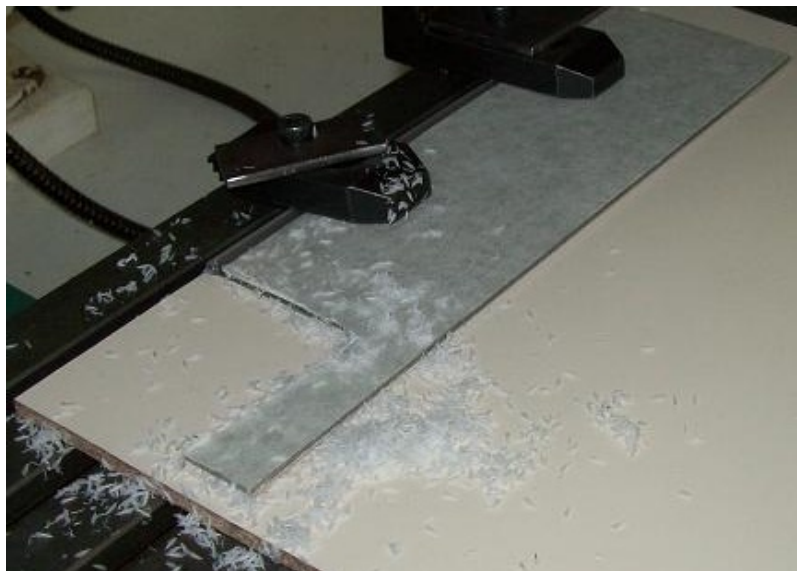
Fig. 4.2.19 Maquinado de material birrefringente.
