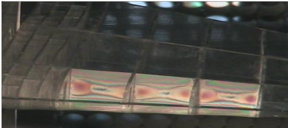
Fig. 5.3.3 h Polariscope a 0^\circ con cuatro motores encendidos.
