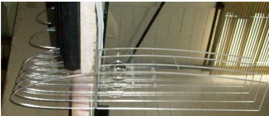
Fig. 4.2.12 Pegado de la sección media de los perfiles.
