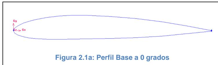
El siguiente paso fue dar la inclinación correspondiente al perfil, con respecto al cuarto de cuerda ya que si bien el ángulo de ataque puede ser simulado dando una inclinación al flujo de entrada, en nuestro caso la inclinación se le hace al perfil, obteniendo de esta forma la figura (2.2).
