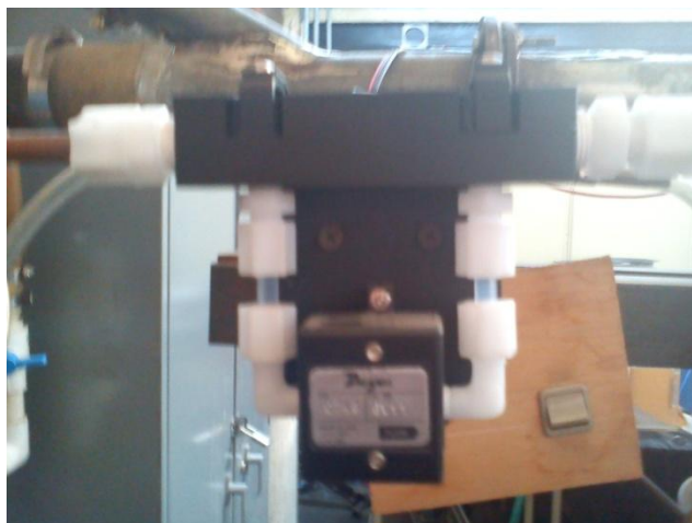
Figura 2.8 Rotámetro tipo turbina para medición de flujo de gas
