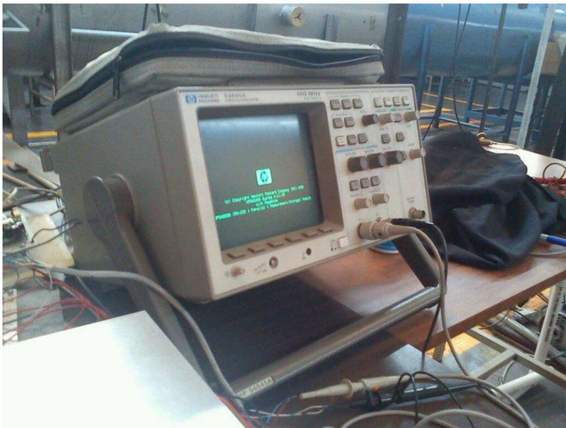
Figura 2.11 Osciloscopio utilizado en las pruebas.
