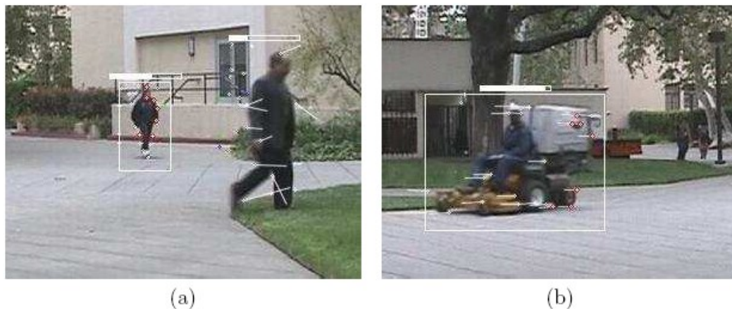
Fig. 2.17. En la figura (a) se muestra un ejemplo de un error de detección, la persona a la derecha no es detectado por el algoritmo, la figura (b) es incorrectamente clasificada como una persona caminando.
