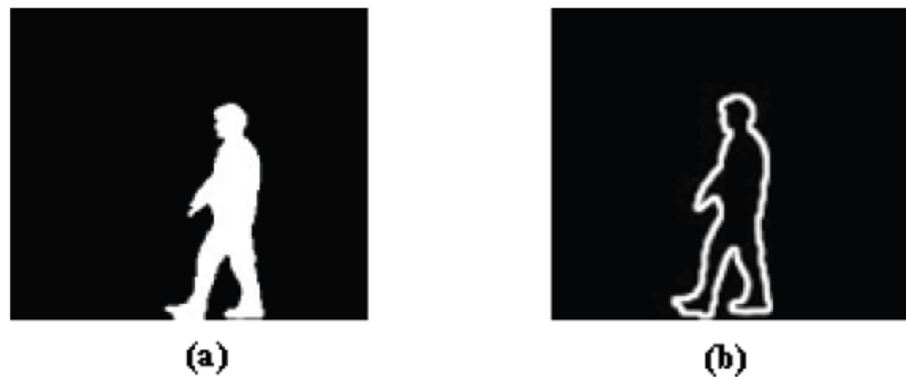
Fig. 6.6. (a) Imagen Segmentada (Silueta), (b) Detección de Borde (Contorno de la silueta).
