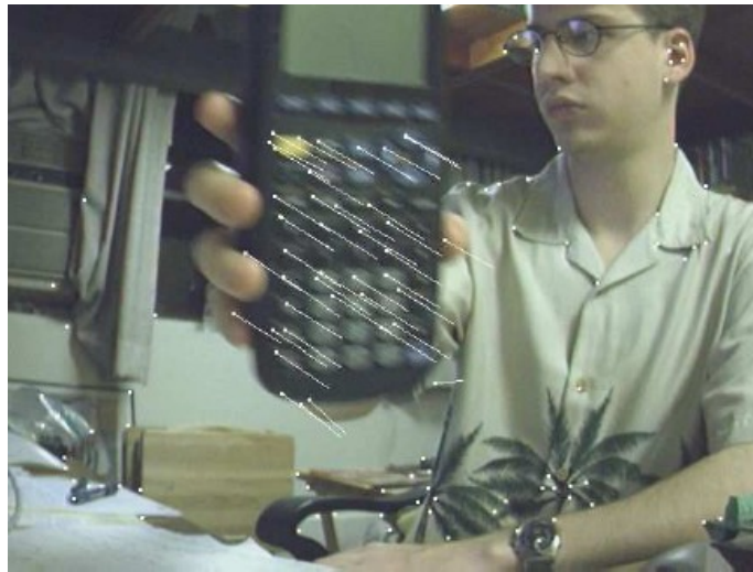
Fig. 2.15. Ejemplo del algoritmo de rastreo de puntos diseñado por Kanade-Lucas_Tomasi.
