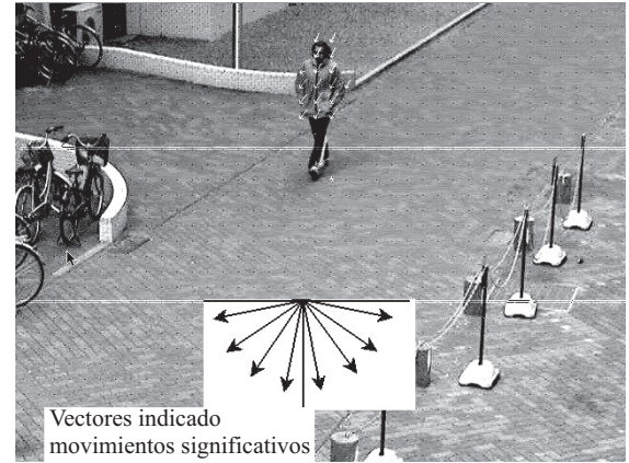
Figura 4 Detección de movimiento significativo en dirección a la zona restringida [16]
