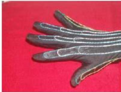
**Figura 4.** Fibras montadas sobre todo el guante
