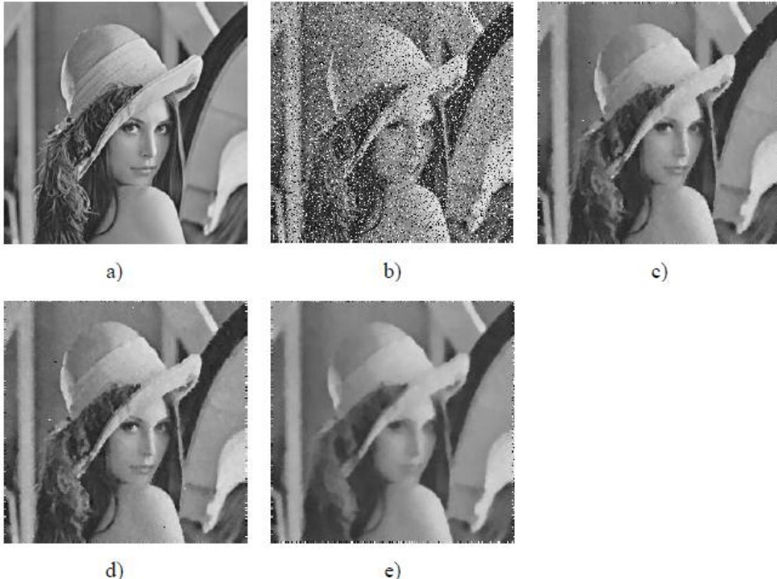
**Figura 1.** Resultados visuales en la imagen "Lena", a) Imagen original "Lena", b) Imagen degradada con 20% ruido impulsivo, c) Imagen restaurada con el filtro propuesto con función de influencia Tukey, sin detector y distribución gaussiana, d) Imagen restaurada con el filtro propuesto con función de influencia Tukey, con detector y distribución gaussiana, e) Imagen restaurada con el filtro  $L$  [7].
