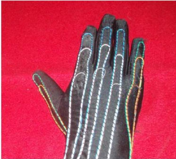
Figura 8. Guante de datos con las fibras ópticas montadas.
