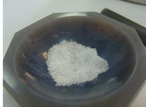
Figura 2.3. Matraz de ágata con LiF:Mg,Ti en polvo.
