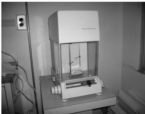
Figura 2.1. Balanza usada para obtener la masa de los dosímetros de LiF:Mg,Ti.
