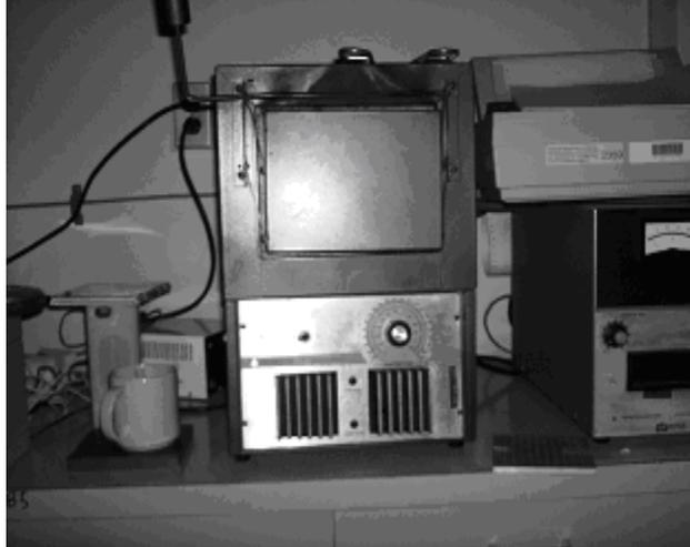
**Figura 2.4.** Horno eléctrico usado para los tratamientos térmicos de borrado.
