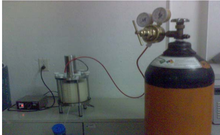
Figura 11. Equipo de Ultrafiltración, de alto rendimiento con agitación del tipo TFF de Millipore.
