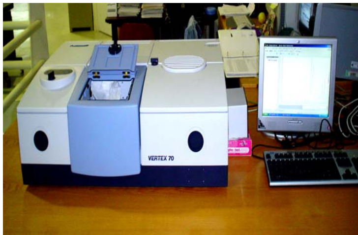
Figura 15. Espectrómetro Infrarrojo de Transformada Rápida de Fourier (FTIR) marca BRUKER modelo VERTEX 70.
