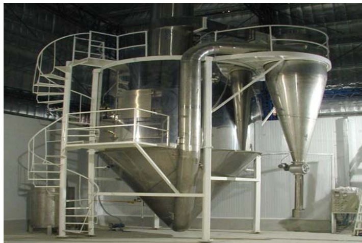
Figura 14. Secador por aspersión Spray dryer “Galaxi Argentina”.
