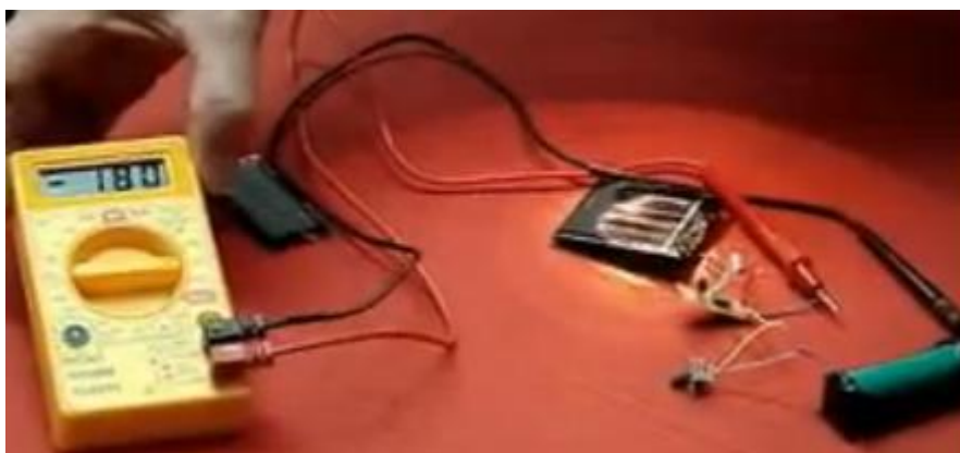
Fig. 88 Circuito apagado acumulando energía con luz solar simulada. Fuente: FGRT11
