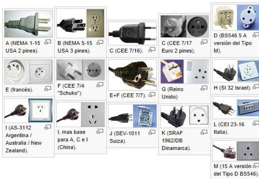
Fig. 91 Tipos de enchufe. Fuente: (WALES, 2012)
