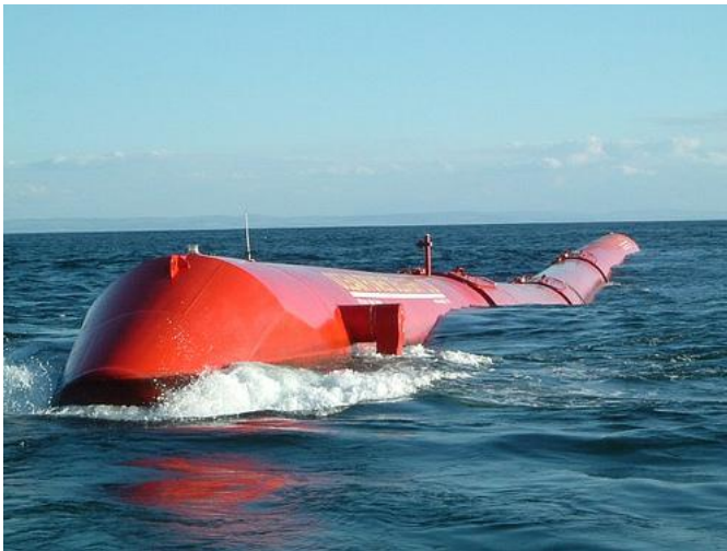
Fig. 22 Sistema generador de energía undimotriz.
