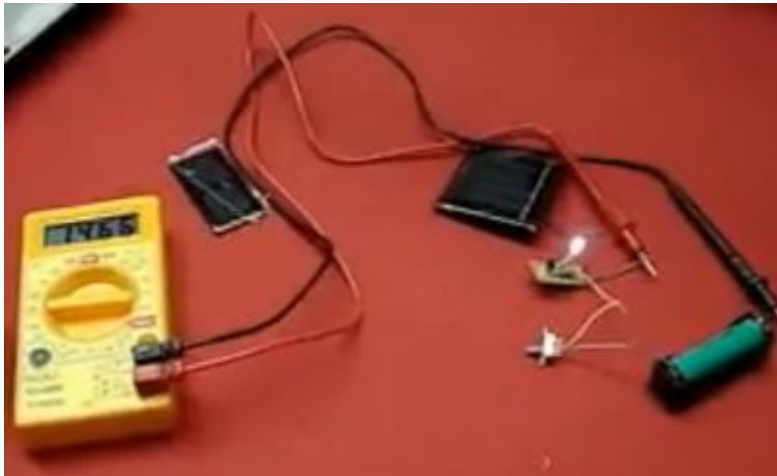
Fig. 89 Funcionamiento del circuito con la carga de la pila o batería. Fuente: FGRT11
