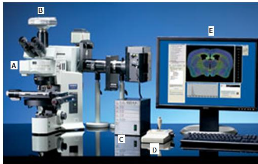
Figura 8. Fotografía del equipo de medición de estereología. a).- Microscopio Óptico, b).- Cámara digital Color CCD, c).- Unidad de control, d).- Palanca, e).- PC con tarjeta de video, programa bioscience stereo investigator, monitor LCD.
