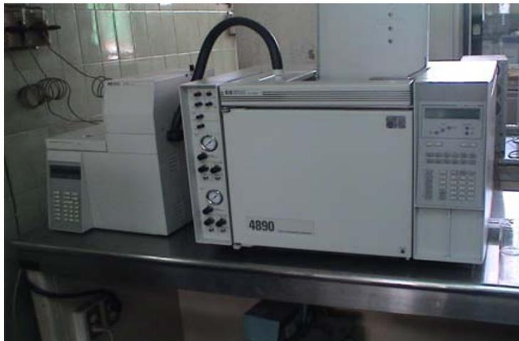
FIG. 6 Cromatógrafo de gases con inyector de Headspace.
