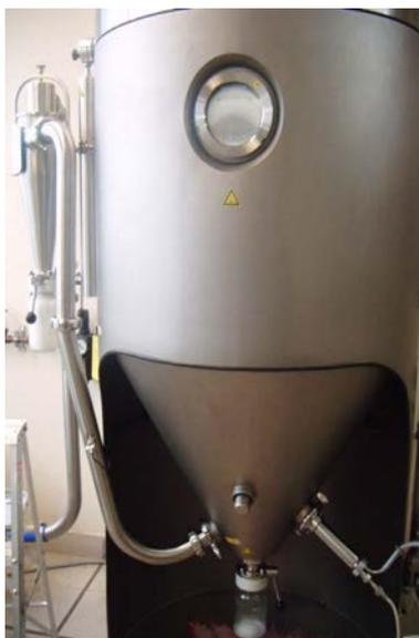
Figura 7. Secador por aspersión Niro MOBILE MINOR™ Spray dryer
