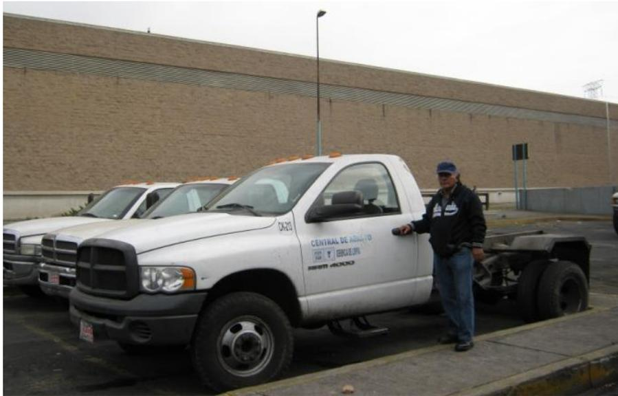
**Figura 13 a.** Equipo de recolección de RSU. Camioneta grúa CK-213 de 5 m<sup>3</sup>.
