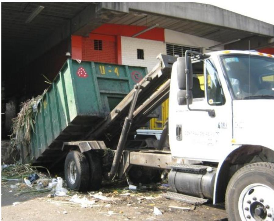
**Figura 13 b.** Mercado de frutas y legumbres. Retiro de contenedor de 17 m<sup>3</sup> con sistema de arrastre por un camión de 17 m<sup>3</sup>.
